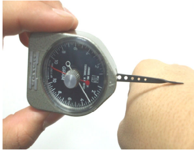
Fig.1.5. Secvență de măsurare a sensibilității tactile cu esteziometrul tactil (Laboratorul de Psihologie Experimentală Gh. Zapan, Facultatea de Psihologie și Științele Educației, Universitatea din București, 2008).
