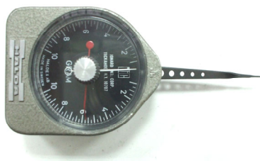
Fig. 1.4. Esteziometru tactil (model suedez). (Laboratorul de Psihologie Experimentală Gh. Zapan, Facultatea de Psihologie și Științele Educației, Universitatea din București, 2008).
